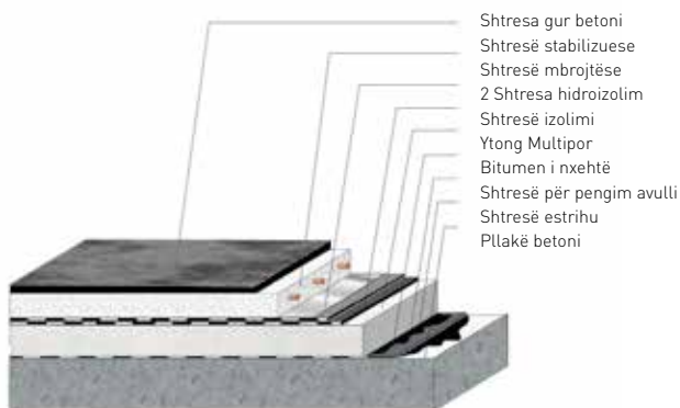
Mbulesë për qarkullim me dy shtresa hidroizolimi
